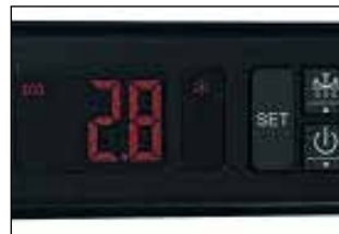
Control de temperatura mediante termostato electrónico digital.
