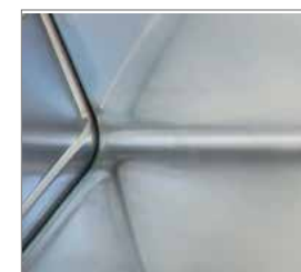
Cantos internos redondeados para facilitar limpieza
