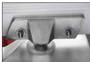
Posibilidad de ajuste plato cuchilla
