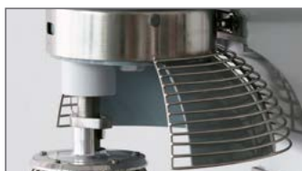
Rejilla de protección
