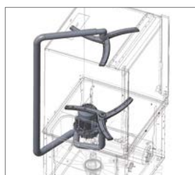
Bomba de doble flujo.
